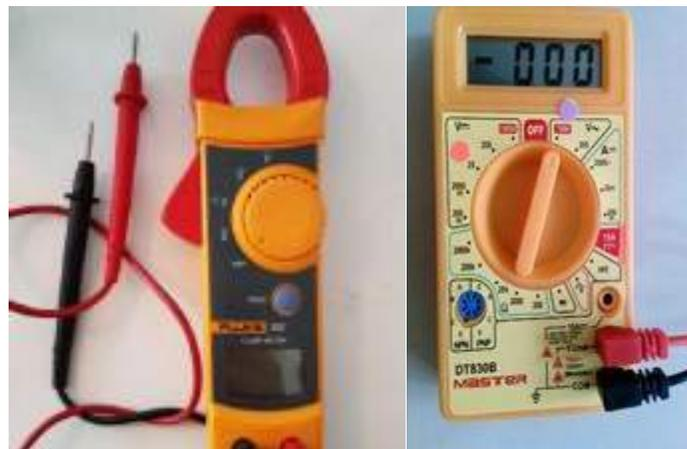
**Figura 3.** Instrumentos de medición. A la izquierda se muestra un Amperímetro de gancho y a la derecha se muestra un multímetro.
